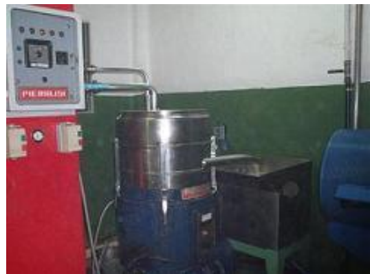
En la centrífuga, por distintas densidades de los líquidos obtenidos, se distribuyen en dos conductos diferentes el aceite y el agua.
