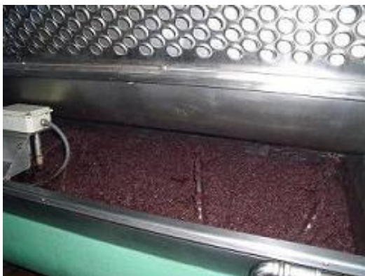
...hasta que se forma la pasta de olivas. Luego, se separa la parte sólida de la líquida, obteniendo el orujo que sale al exterior y el líquido que pasa a la centrífuga.
